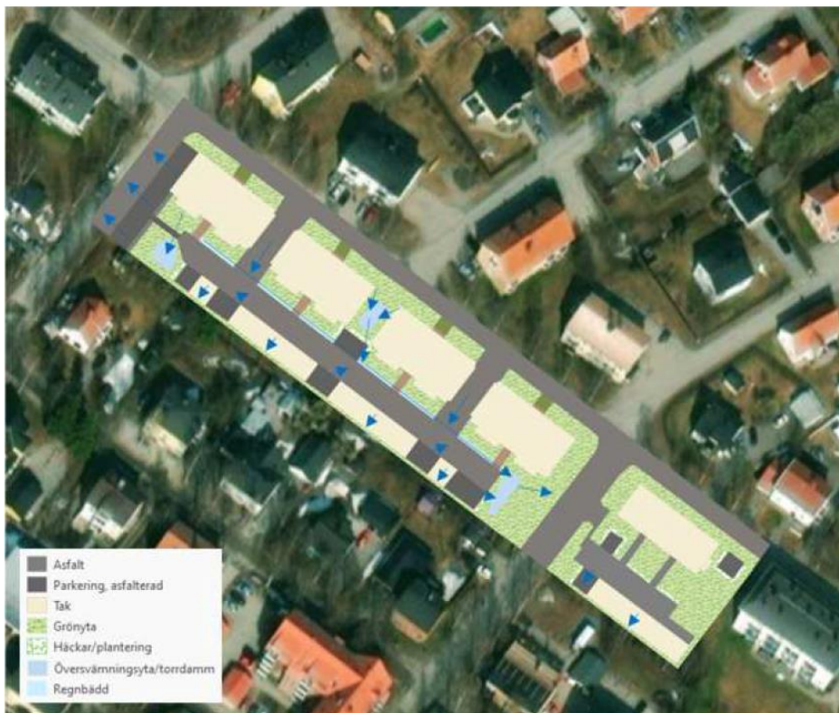
Figur 16. Dagvattenlösningar Staren m.fl, flödespilar visar föreslagen lutning/avledning av dagvattnet till dagvattenanläggningarna (Norconsult, 2023).
