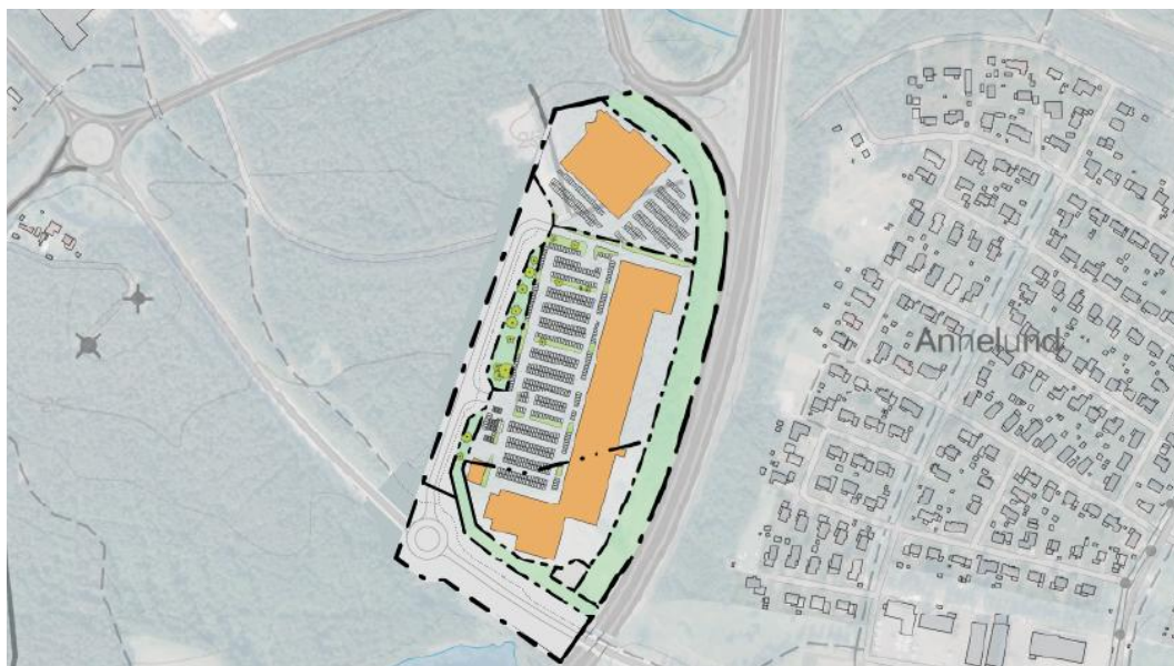
Figur 9. Illustration av planförslaget med handelsbyggnader, parkeringar, fristående restauranger, laddningsstation för elbilar, samt de ytor som krävs för hantering av dagvatten. Bildkälla: (Piteå kommun, 2025)
