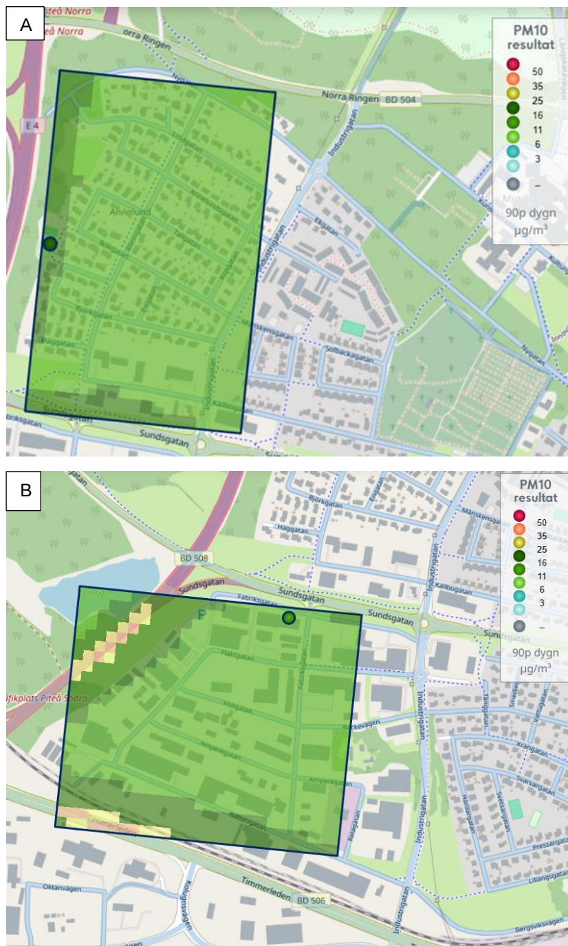
Figur 13. Områdesberäkningar i SIMAIR för 90e percentilen av PM10 för planscenariot med handelsplats år 2040. A) visar beräkningar för bostadsområdet Annelund och B) visar beräkningar för Backcity. Korrektionsfaktor har inte applicerats på halterna i figuren.
