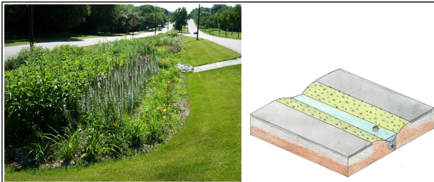
Figur 14 Exempel på svackdike, med växter för extra rening under växtsäsong (Milford, 2025) och principskiss för utformning av svackdike (VA-guiden, 2025).
