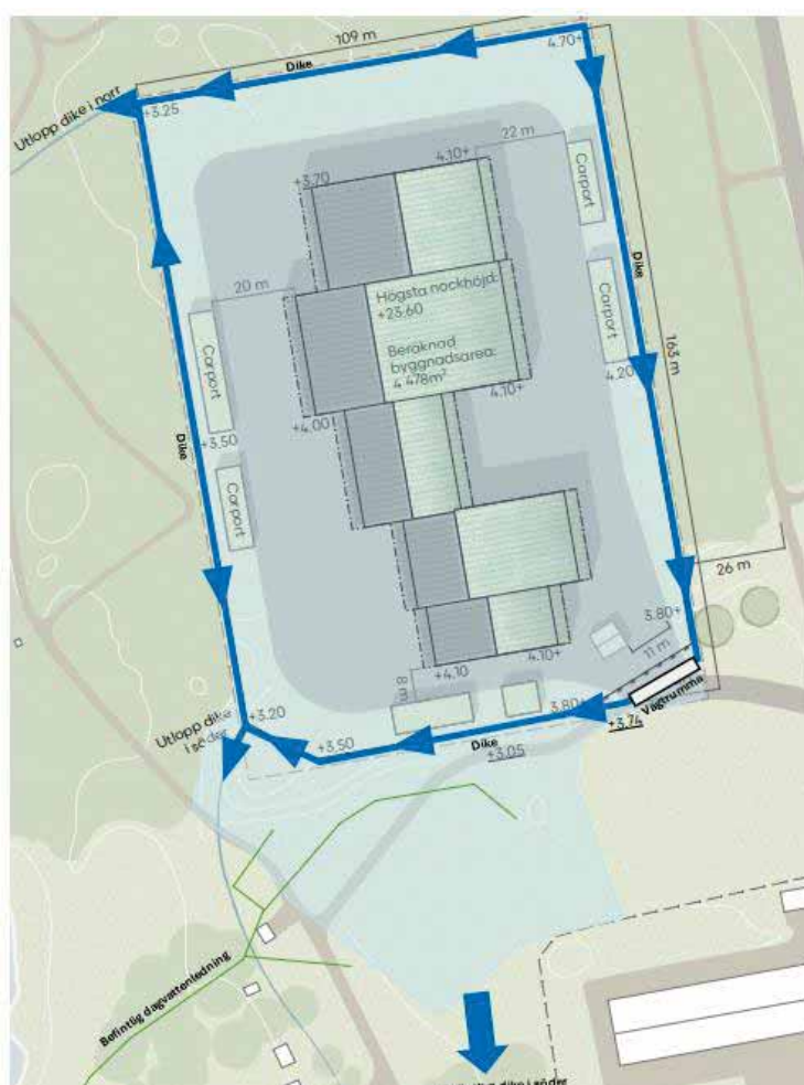
Figur 6. Förslag till dagvattenlösning. Diken placerade runt fastigheten för nytt vattenverk.
