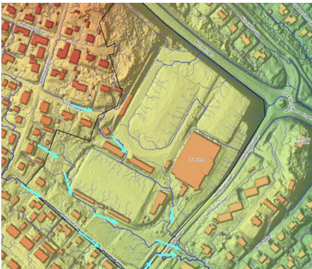
Figur 10. Bild från dagvattenutredningen (Norconsult) som visar topografi och flödesvägar (mörkblå linjer). Pilarna i cyan visar flödesriktningen genom planområdet till Djupviksgatan.
