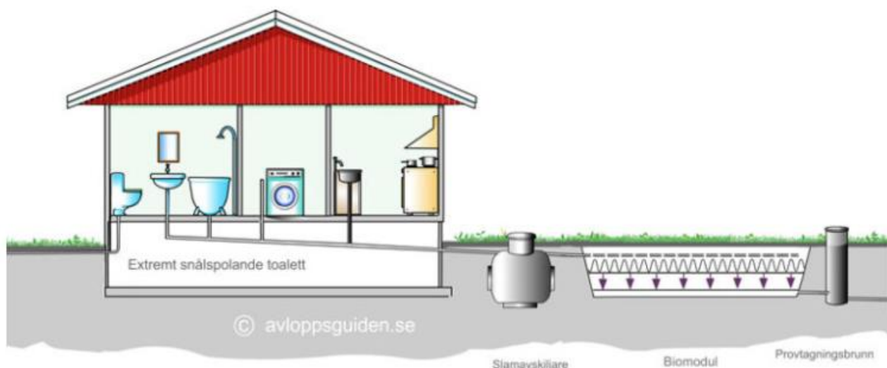
Figur 8-3. Principbild biomoduler (Avloppsguiden, 2025b)
